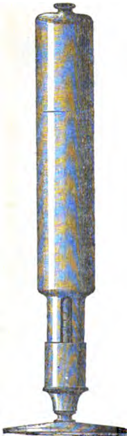
Vereinfachtes Lactoscop von Dietzsch.
